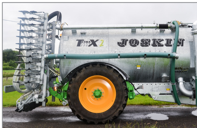
De Tetrax2 mengmestverspreiders zijn zeer compact en de verspreidingswerktuigen worden zeer dicht bij de tank gekoppeld
