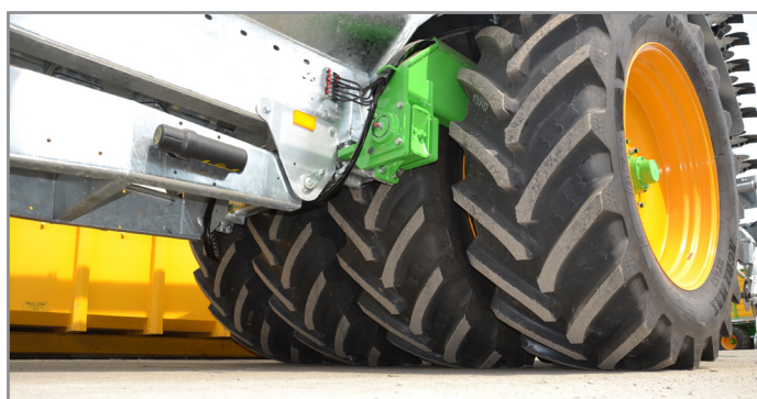
De 4 wielen met dezelfde afmetingen 650/85R38 (Ø 2.070 mm) naast elkaar maken het mogelijk om het merendeel van het gewicht van het voertuig op de grond uniform te verdelen.
